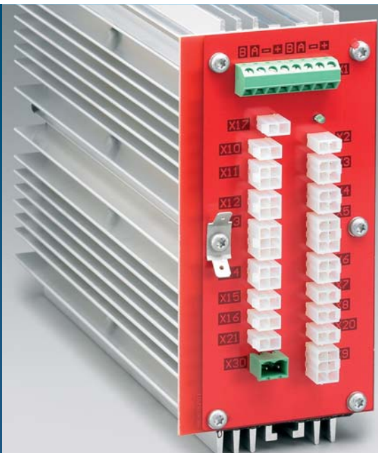
Electrónica de control patentada integrada en los rodillos
